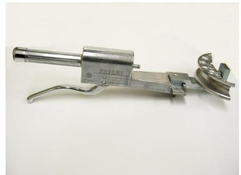
2. 逆曲げ用部品 1 にチューブのサイズに適合するホイールを取りつけます。
